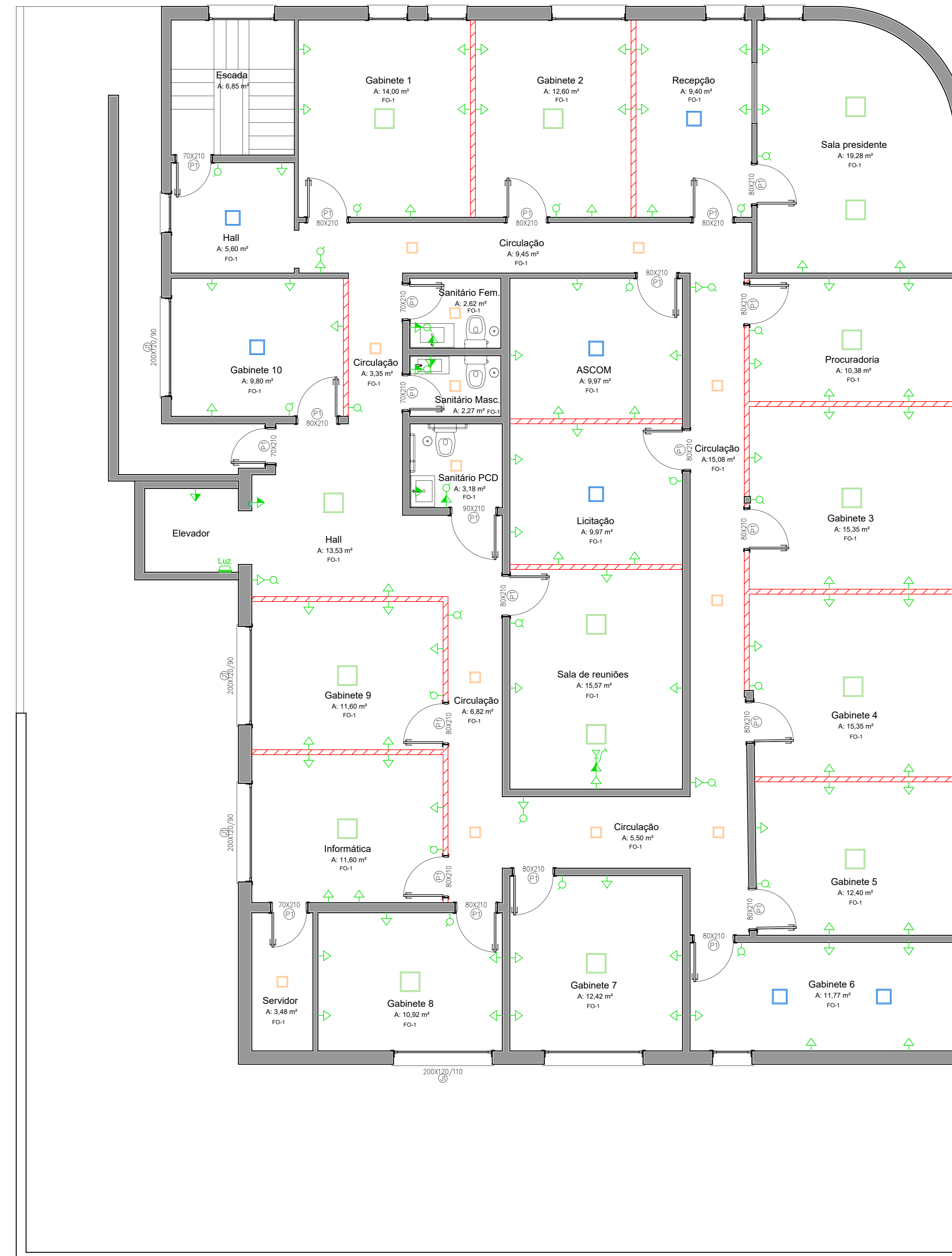
PONTOS DE ELÉTRICA E FORRO 2º PAVIMENTO
