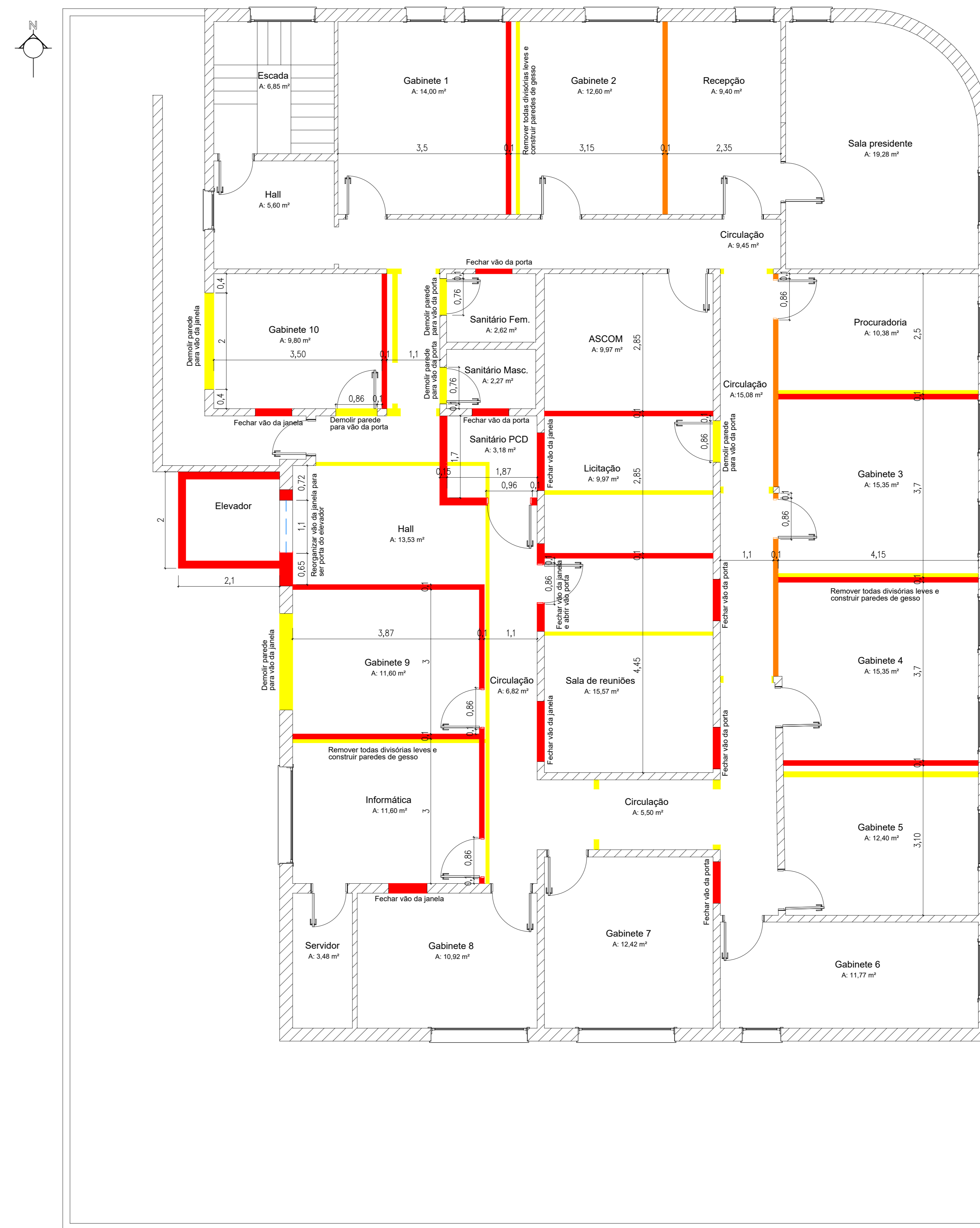
PLANTA DEMOLIR/ MANTER/ CONSTRUIR 2º PAVIMENTO
